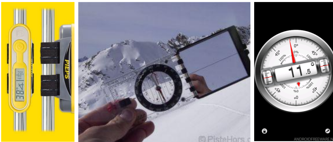
Figura 3. Diferentes modelos de clinómetros: digital, integrado en la brújula o dentro del smartphone. No importa cuál se elija, la cuestión es tener claro en qué pendiente nos encontramos (fuente: Piesps, Pistehors.com i Androidfreeware.com).
