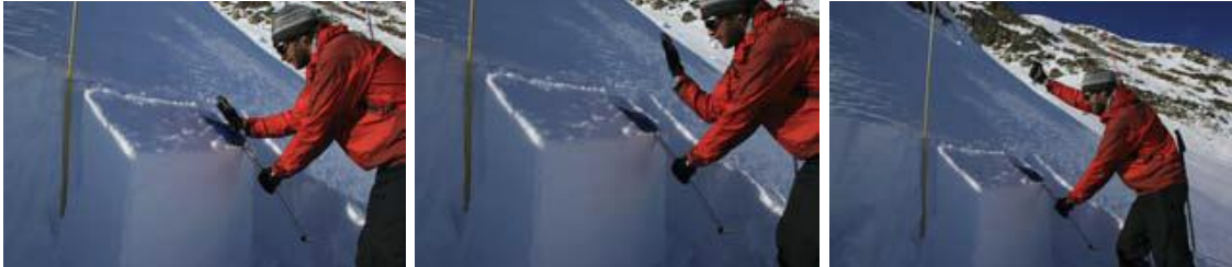
Figura 32. Test de la columna extendida. La sobrecarga se aplica a un extremo del bloque, articulando primero la muñeca, luego el codo y finalmente el hombro (autor: Jordi Gavaldà).
