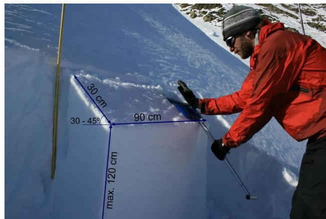
Figura 31. Test de la columna extendida. Medidas del bloque a aislar y zona donde aplicar la sobrecarga (autor: Jordi Gavaldà).
