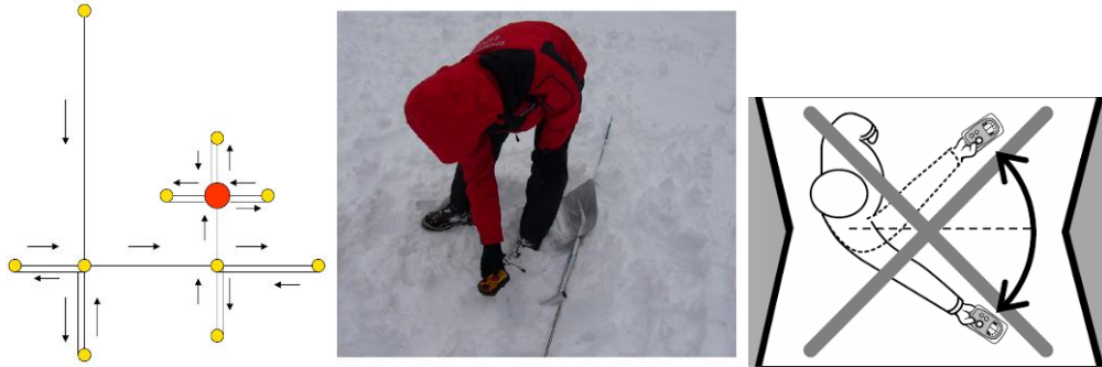
Figura 11. El método de la cruz en la búsqueda terciaria requiere situar el DVA cerca del suelo y hacer las cruces tan perpendiculares como nos sea posible. Es indispensable mantener la misma orientación del aparato en todo momento y no hacer movimientos giratorios con el brazo (fuente: Barryvox user's manual).
